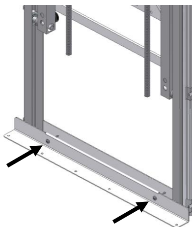
6.2.2 Bundskinnen monteres og fastspændes med 2 skruer.
