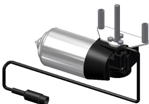
6.6.1 Motoraksel med påmonteret stopring monteres igennem bagpladen og ind i gearhuset.
